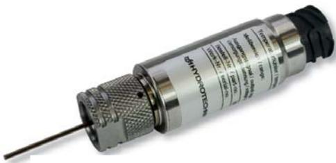
Специальная серия температурных датчиков моделей HySense® TE 2.. является ручным датчиком для мобильного использования. Щуп или измерительная пластина может погружаться непосредственно в среду (жидкость) или позволяет выполнять измерения температуры поверхности. Диапазон измерения температуры в пределах -50 до +400 °C.
